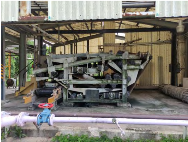
Figura 14 Filtro banda para desaguado de lodo; sistema de preparación de polímero
