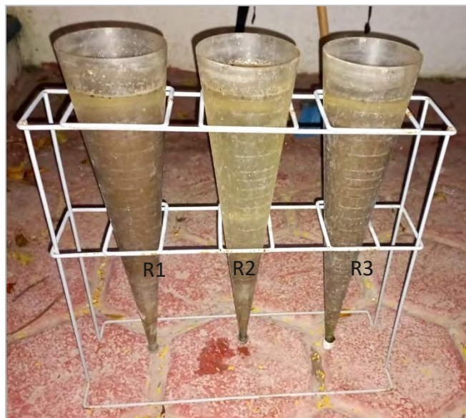
Figura 18 Pruebas de sedimentabilidad PTAR Saas Tun Há
