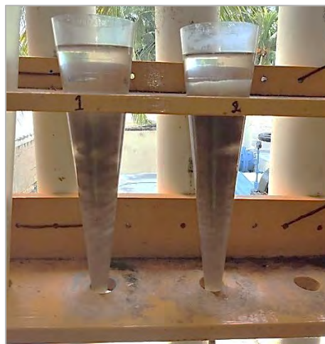
Figura 22 Prueba de Sólidos Sedimentables PTAR El Rey
