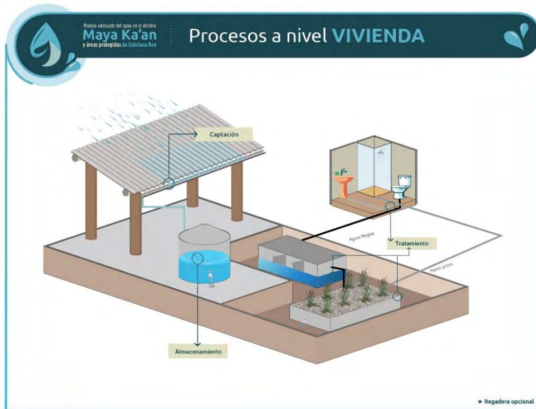
Figuras 30 y 31. Ecotecnologías que conforman el paquete de instalación.
