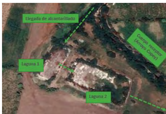
Imagen satelital del sistema lagunar para el tratamiento de aguas residuales de Sabana
